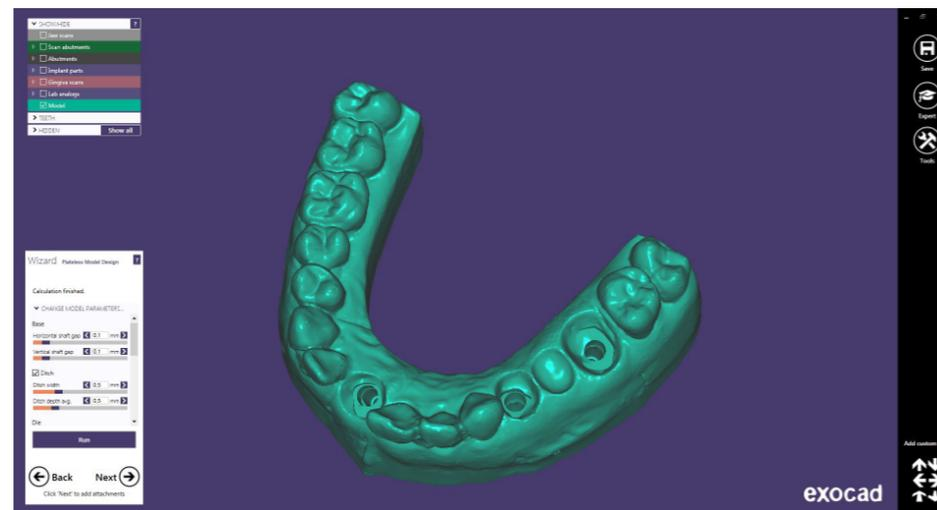
Finalmente podemos observar el modelo en diferentes vistas y observar el orificio para la réplica digital y el orificio con la réplica virtual colocada.
