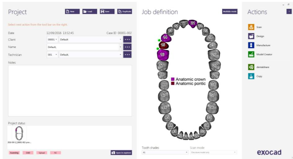
En esta pantalla se define cliente, paciente, técnico, tipo de trabajo, materiales, etc. Se define completamente el trabajo sin especificar marca y modelo de implante.
