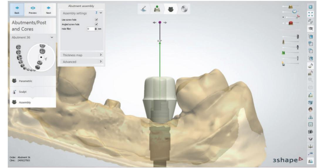
Como se puede observar en la imagen anterior, el canal automáticamente está posicionado en 0°.
