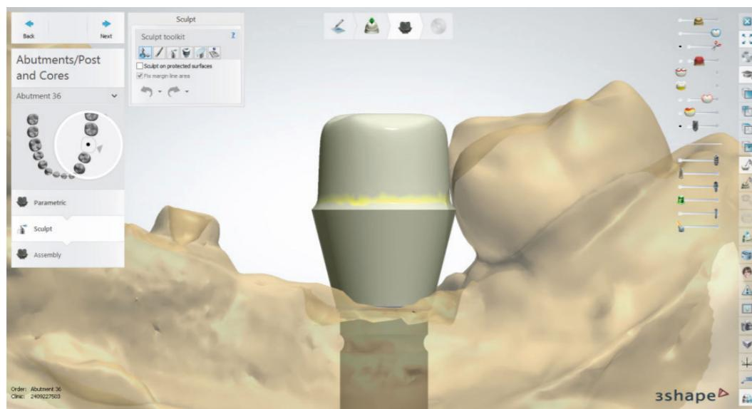
En último lugar se procede al diseño del canal angulado. Para ello ha de marcarse la casilla "Angle Screw Hole".
